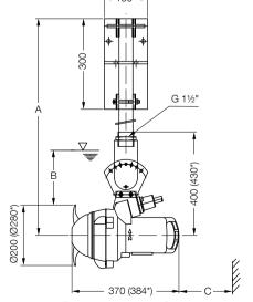
$\mathbf{A} = \text{max. 2 m}$   $\mathbf{B} = \text{min. 400 mm}$   $\mathbf{C} = \text{min. 450 mm}$ \* RW 280
